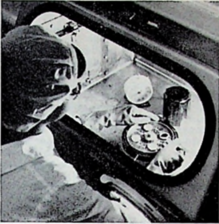
Afb. 18 - Het afdekken van de siliciumplakken met lichtgevoelige lak.
